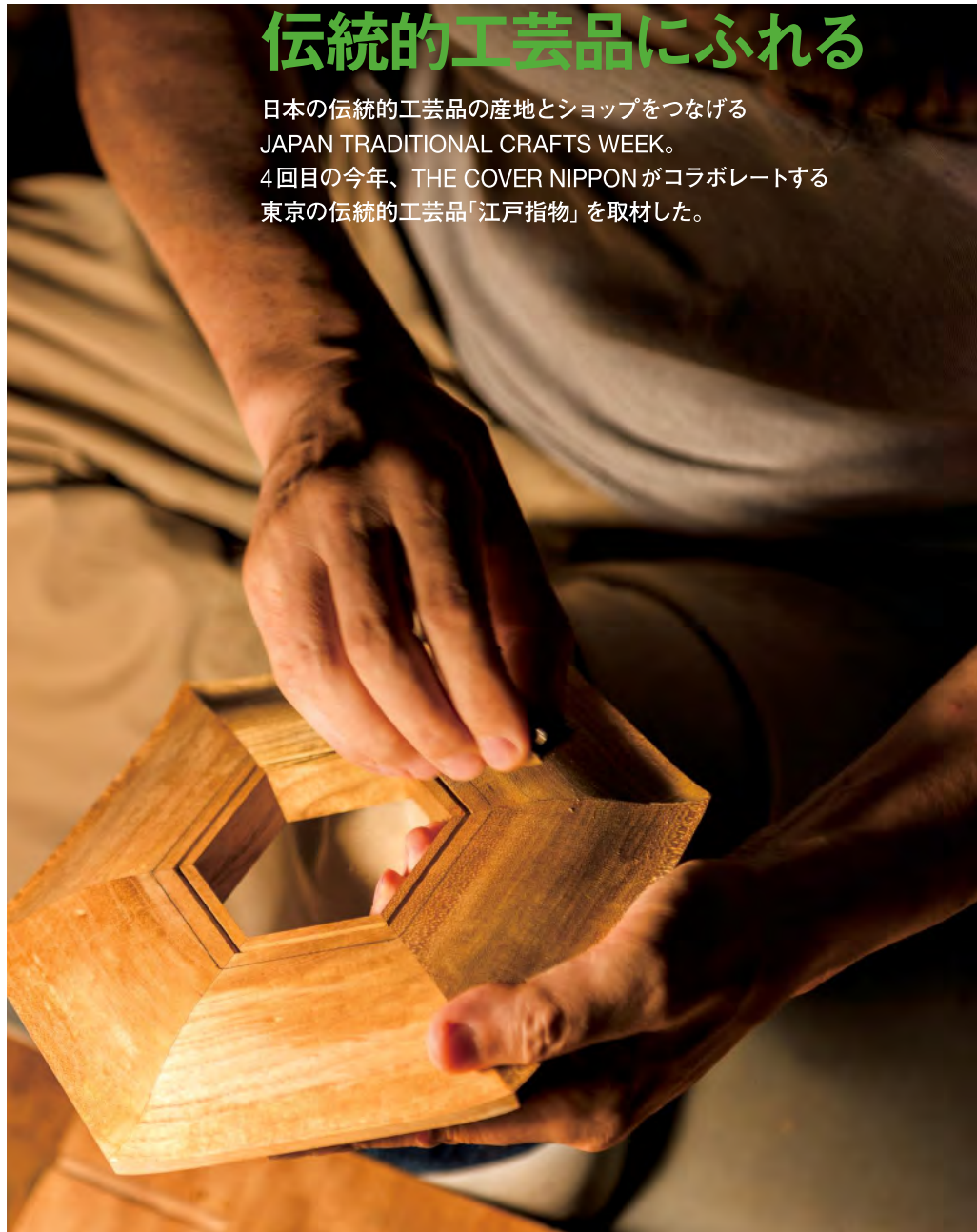
製作中の島桑の御厨子。表面を究極の滑らかさになるまで磨き続ける。その後の漆塗り美しく堅牢に仕上げるための非常に重要な作業。
